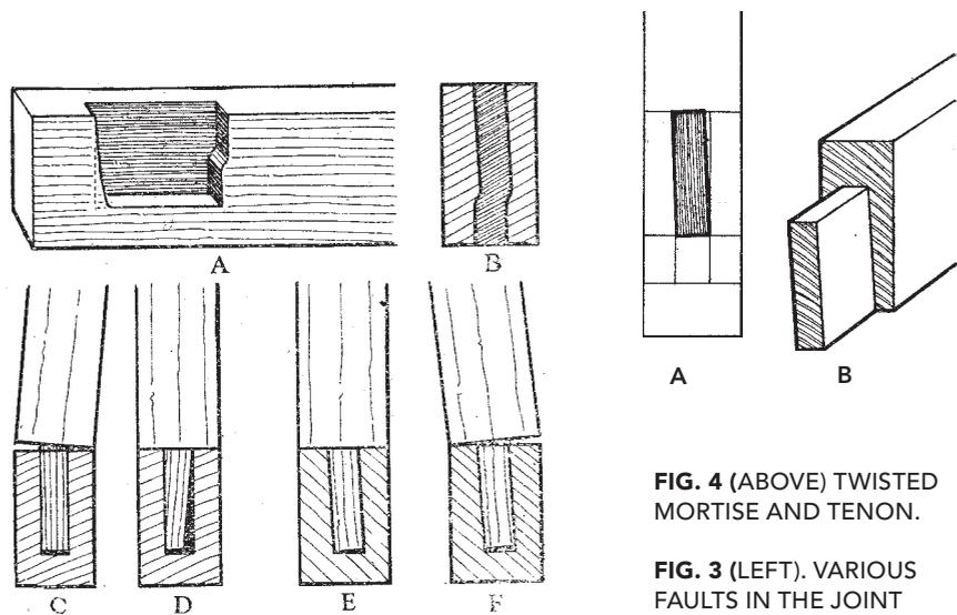
FIG. 4 (ABOVE) TWISTED MORTISE AND TENON.
