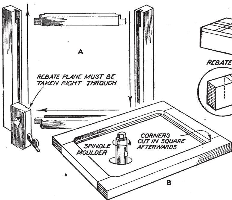
FIG. 2. A. HOW REBATING NECESSITATES LONG BACK SHOULDERS
