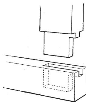
**FIG. 1. COMPLETED JOINT SHOWING HAUNCH**
