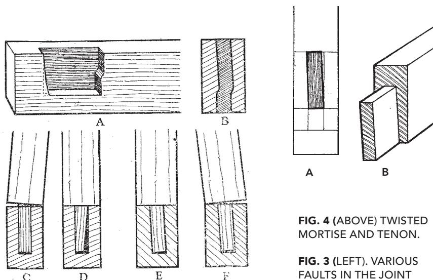
FIG. 4 (ABOVE) TWISTED MORTISE AND TENON.
