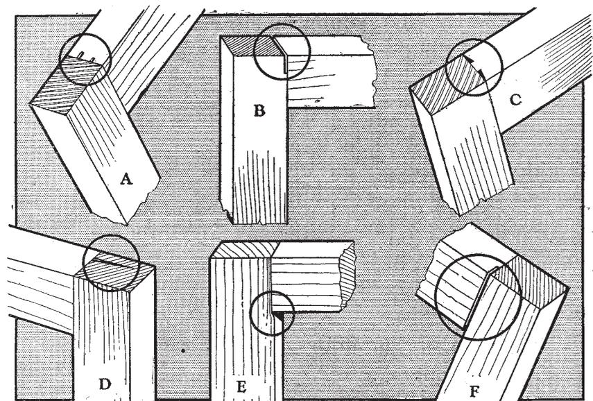
**FIG. 2. THINGS TO AVOID WHEN MAKING THE MORTISE AND TENON JOINT.**
