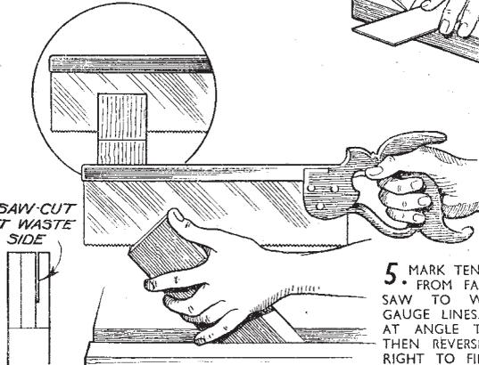
5. MARK TENON WITH GAUGE FROM FACE SIDE. WORK SAW TO WASTE SIDE OF GAUGE LINES. HOLD WOOD AT ANGLE TO START CUTS, THEN REVERSE AND FIX UPRIGHT TO FINISH (SEE INSET)
