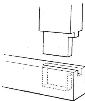
**FIG. 1. COMPLETED JOINT SHOWING HAUNCH**
