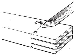
FIG. 3. MAKING SLOPING GROOVE AT SHOULDERS
