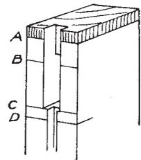
**FIG. 3. HOW A GROOVE IS STOPPED ALONGSIDE A MORTISE**
