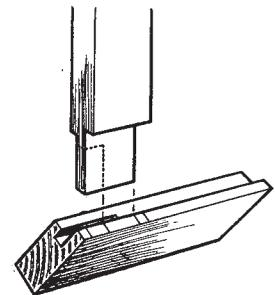
8 FINAL STAGE IS TO CUT GROOVE FOR HAUNCH AND MARK OUT PART OF TENON TO BE CUT AWAY. JOINT SHOULD FIT HAND TIGHT.
