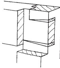
**FIG. 2. SHOWING SQUARE HAUNCHED TENON WEDGED.**
