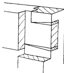
**FIG. 2. SHOWING SQUARE HAUNCHED TENON WEDGED.**
